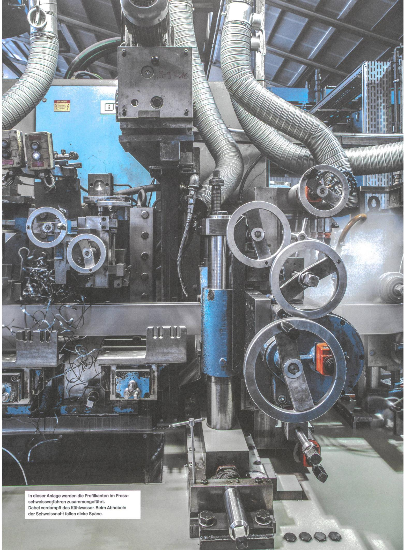
In dieser Anlage werden die Profilkanten im Pressschweißverfahren zusammengeführt. Dabei verdampft das Kühlwasser. Beim Abhebeln der Schweissnaht fallen dicke Späne.
