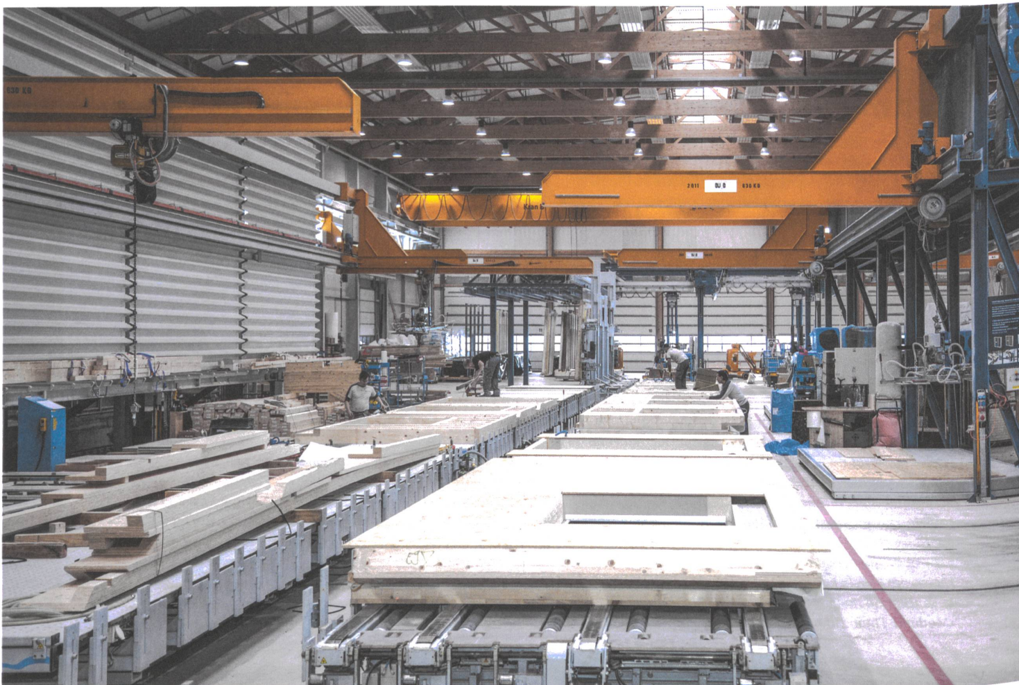
In der Halle der Holzbaufirma Renggli entstehen fertige Wand- und Deckenelemente. | Des éléments de mur et plafond prêts à l'emploi voient le jour dans l'atelier de l'entreprise de construction en bois Renggli.
