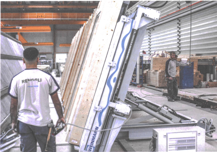
Der Schmetterlingstisch wendet die Elemente maschinell. | La table papillon retourne les éléments mécaniquement.
