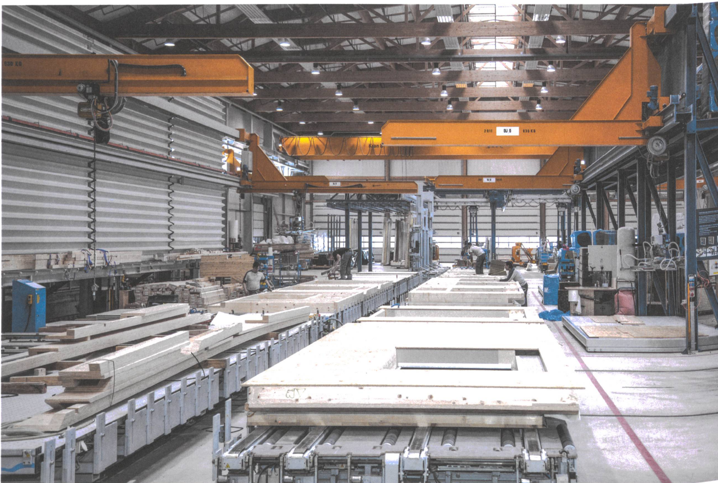
In der Halle der Holzbaufirma Renggli entstehen fixfertige Wand- und Deckenelemente. | Des éléments de mur et plafond prêts à l'emploi voient le jour dans l'atelier de l'entreprise de construction en bois Renggli.
