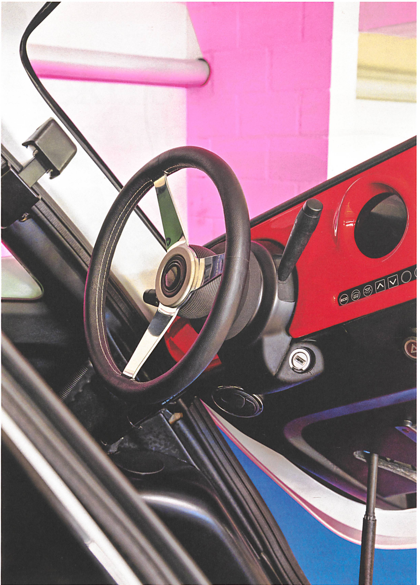
Die Innenausstattung ist rudimentär, Navigationssystem und Klimaanlage fehlen. Gewicht und Energieverbrauch würden die Reichweite verkleinern.
