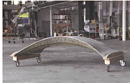
Schalung aus Stoff: Block forscht derzeit an komplexen Geweben, die eine Maschine strickt und die mit Beton bestrichen aushärten. Fotos: ETH Zürich, Block Research Group
