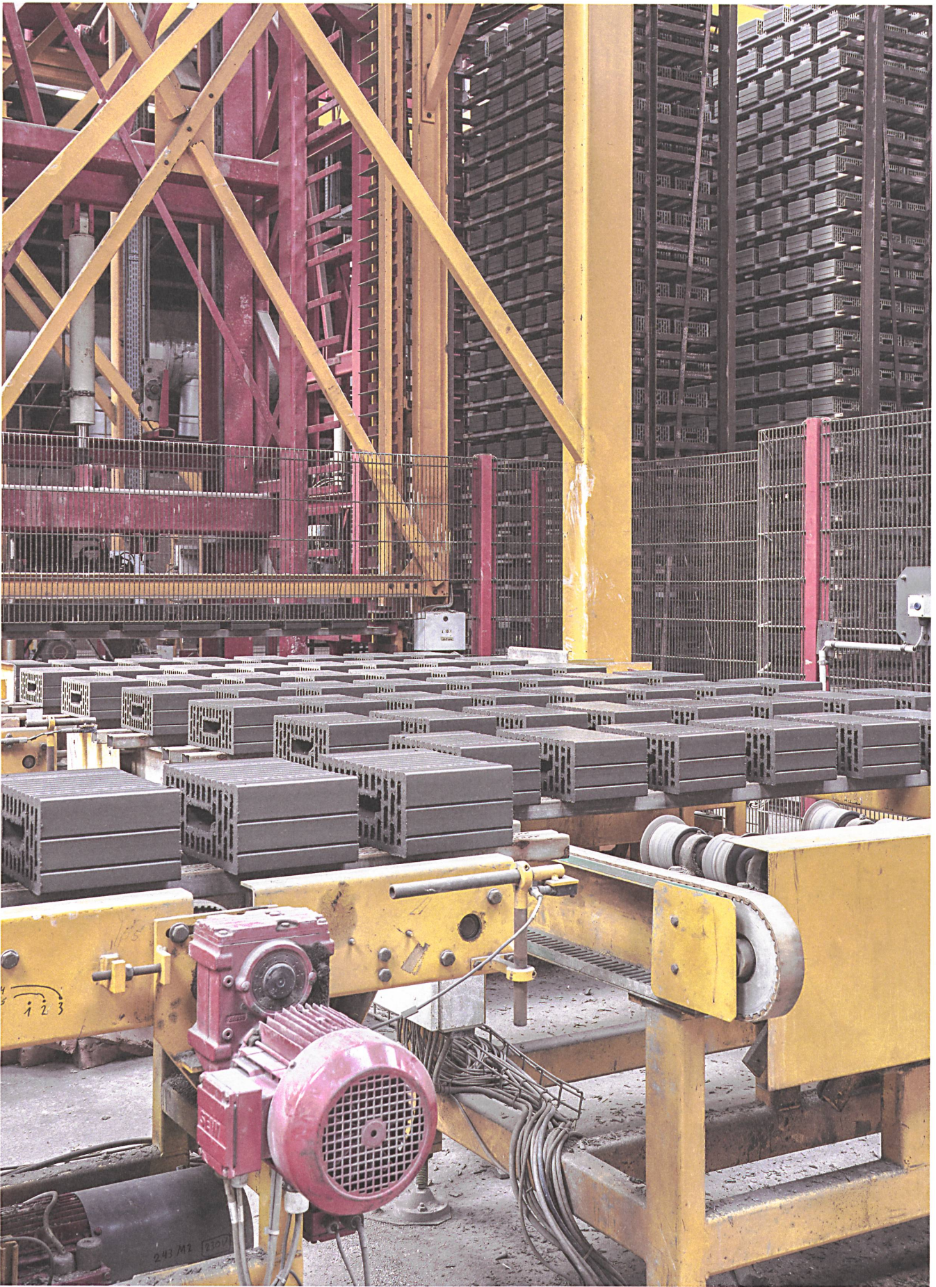
Trocknen: Die feuchten Rohlinge wandern über den Elevator auf Trockenträger aus Aluminium und in hohen Stapeln weiter in die Trockenkammern.
