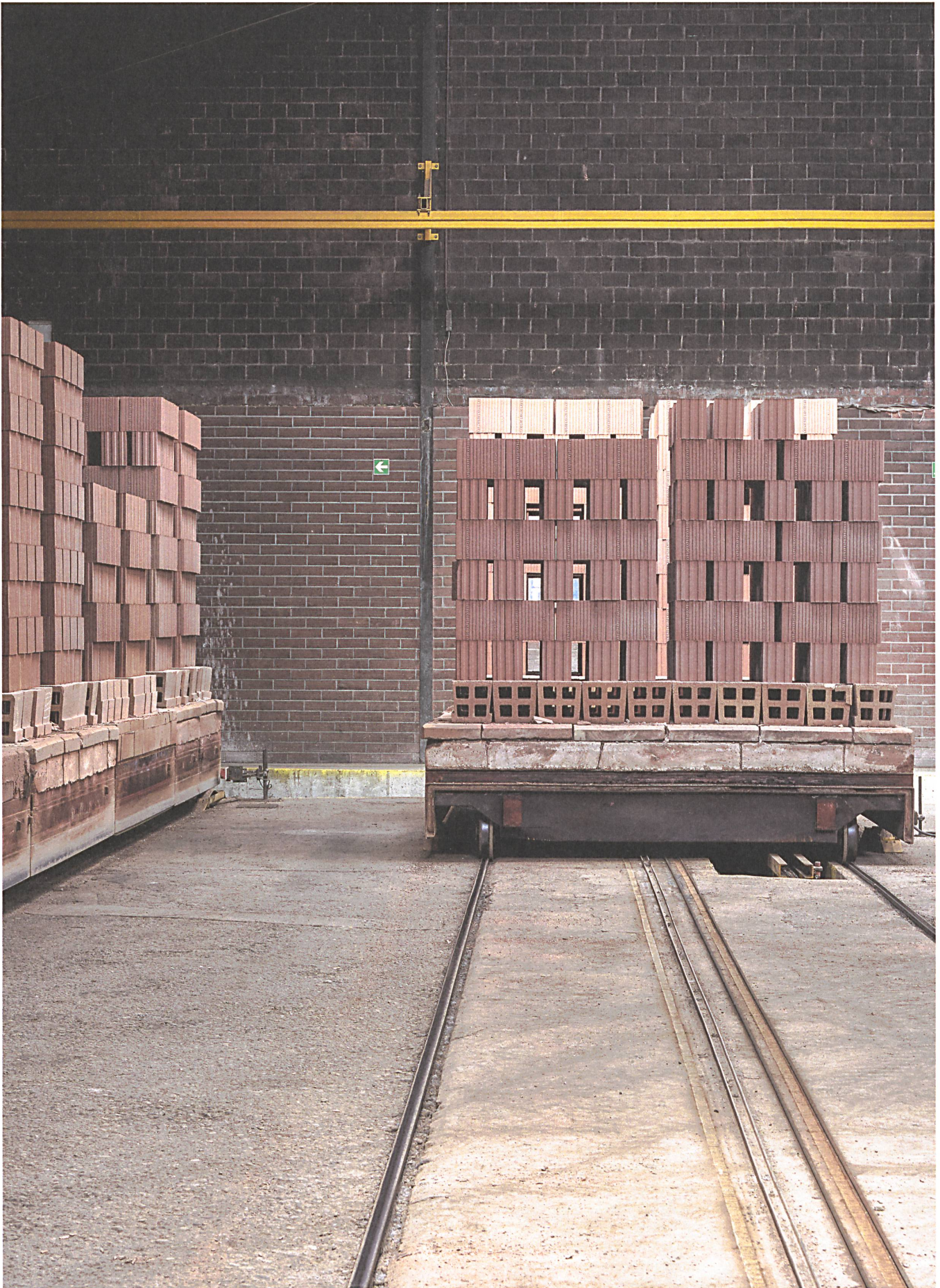
Ein Ofenwagen pro Stunde verlässt den Tunnelofen. Am Wochenende arbeitet er vollautomatisch, sodass montags beim Wagenbahnhof fast fünfzig bestapelte Wagen stehen.
