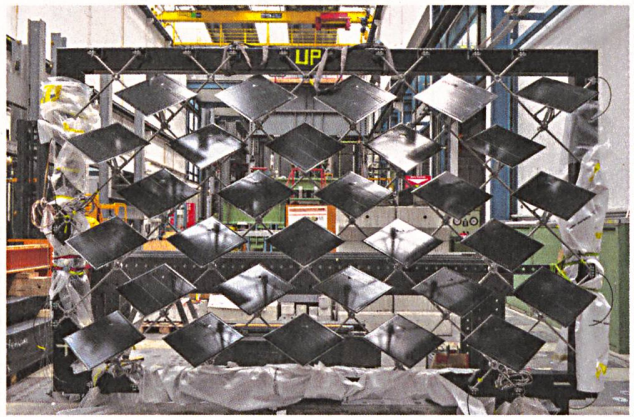
Ein Prototyp der Adaptive Solar Facade in der Werkstatt.
