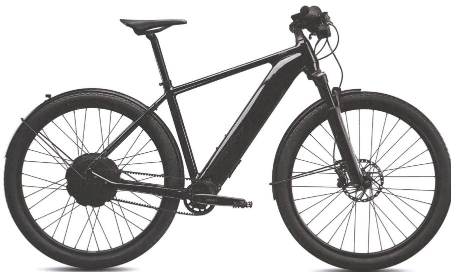
Sportlich unterwegs auf der Langstrecke: Der Antrieb des Elektrobikes «Code» verbirgt sich im Hinterrad, der Akku liegt im Unterrohr versteckt.
