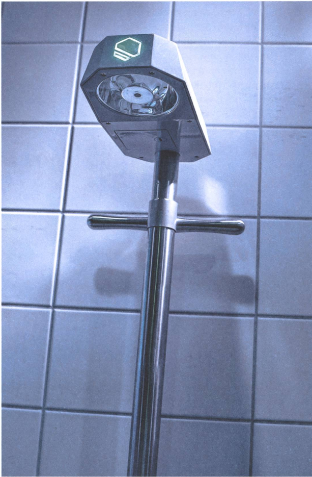
Die Kamera erfasst, welcher Art die Abfälle sind und speist sie in eine Datenbank.
