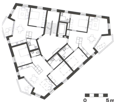
Das Regelgeschoss mit zwei 3½-Zimmer-Wohnungen und einer 2½-Zimmer-Wohnung ist in beiden Häusern identisch.
