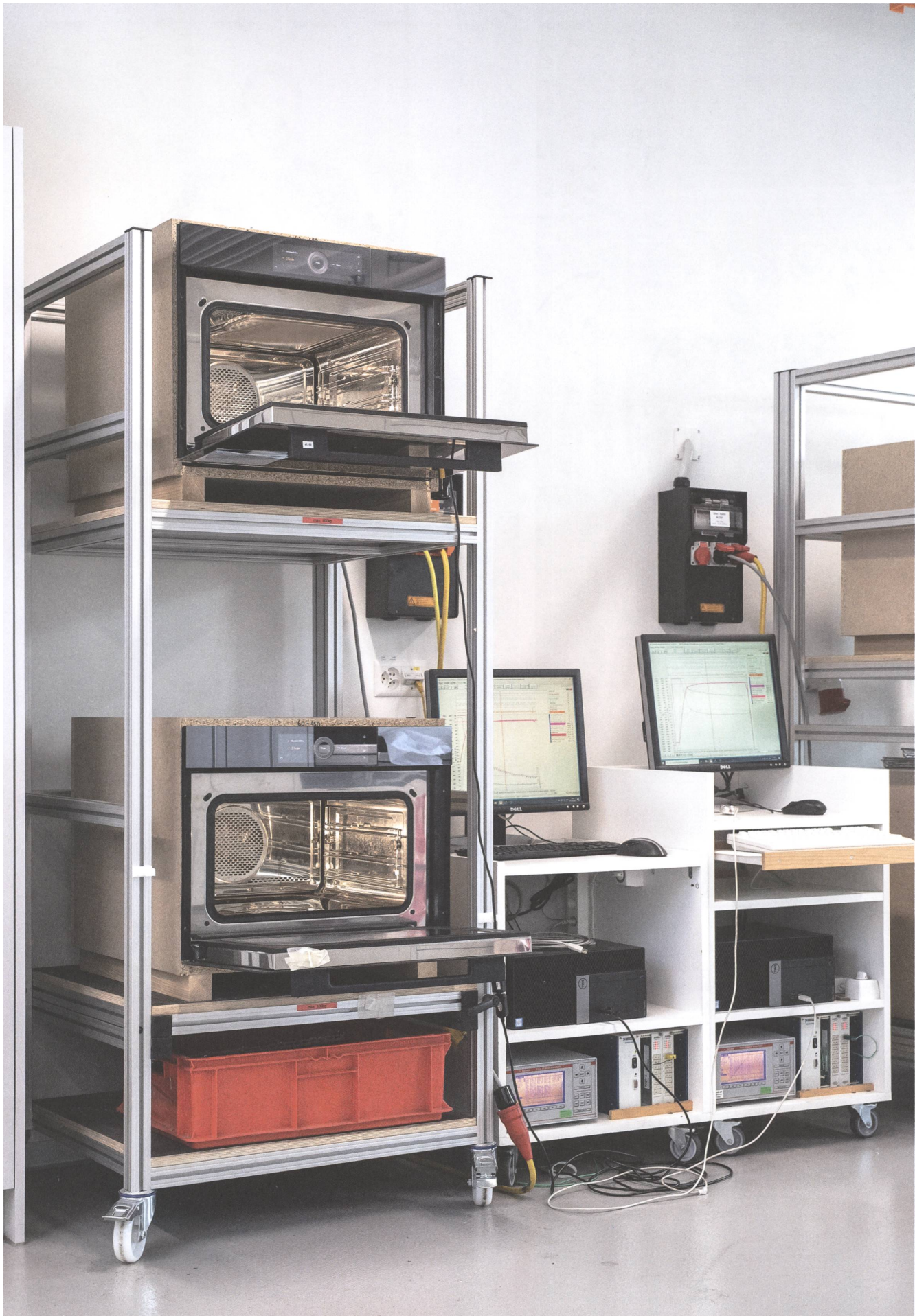
Backöfen der nächsten Generation im Dauer-Funktionstest.
