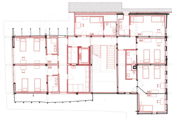
Obergeschoss mit Gästezimmern.
