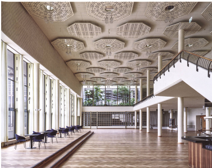
Das Tondhalle-Foyer ist einer der architektonischen Höhepunkte des Gebäudes. Es wurde sorgfältig saniert, die Leuchten hat man entsprechend den Originalen aus dem Jahr 1939 nachgebaut.
