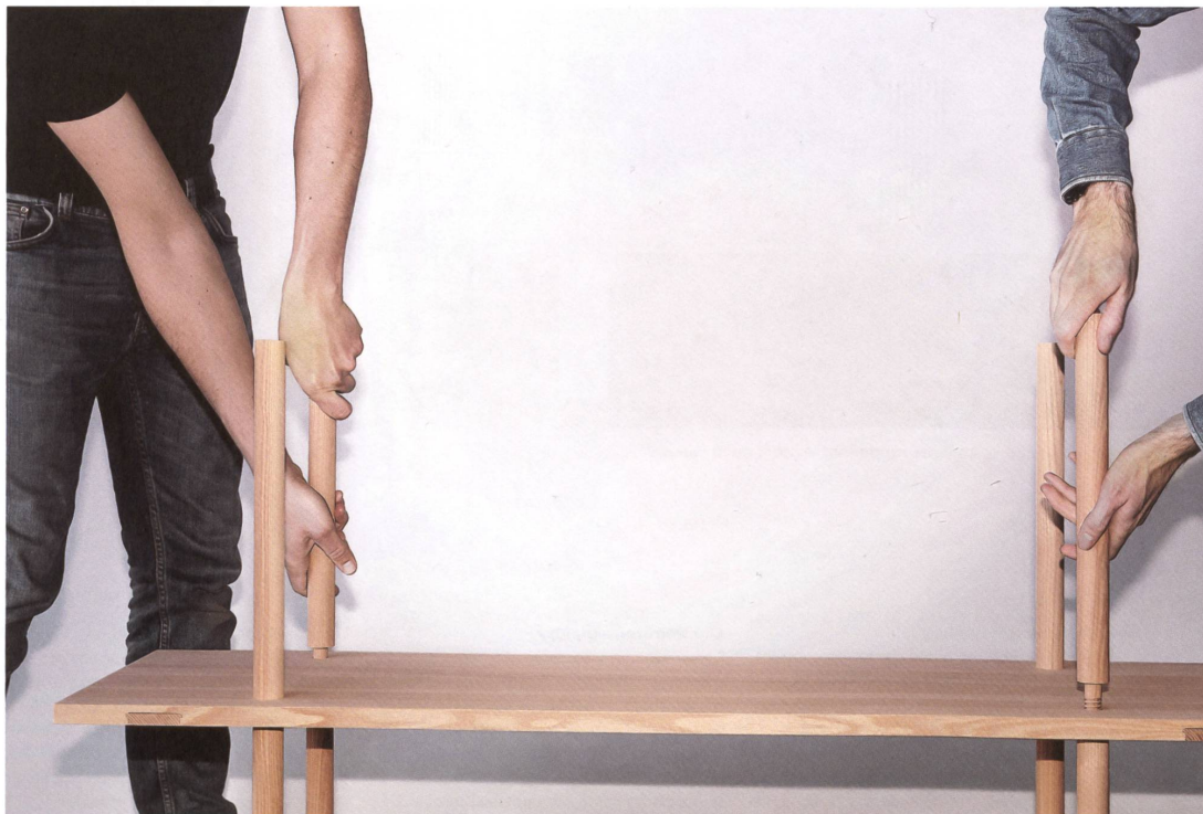
Ohne Leim und Metall gefügt: Die Holzstäbe des Regals 001 werden ineinandergeschraubt. Fotos: Zsigmond Toth
