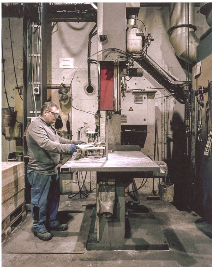
Ein Arbeiter trennt die Giesssstruktur vom eigentlichen Gussteil ab, das danach abgeschliffen wird.
