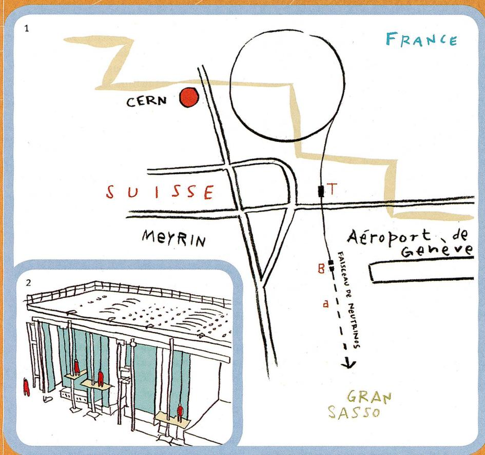
**III. 1** Dans l'accélérateur de particules SPS du CERN, des protons de très haute énergie bombardent une cible de graphite (T), donnant naissance à des particules chargées positivement : des pions et des kaons. Un système de lentilles magnétiques les focalise en un faisceau parallèle dirigé vers le Gran Sasso. Le long d'un tunnel de 1000 mètres, ils se désintègrent ensuite en partie en muons et neutrinos du muon.
