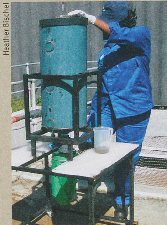
Ce réacteur transforme l'urine en struvite, un fertilisant solide moins problématique.
