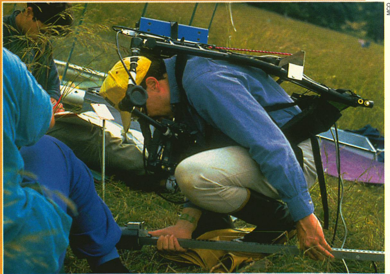
Pflanzenwurzeln lassen sich durch eine Spezialkamera mit unterirdischer Optik beobachten.
