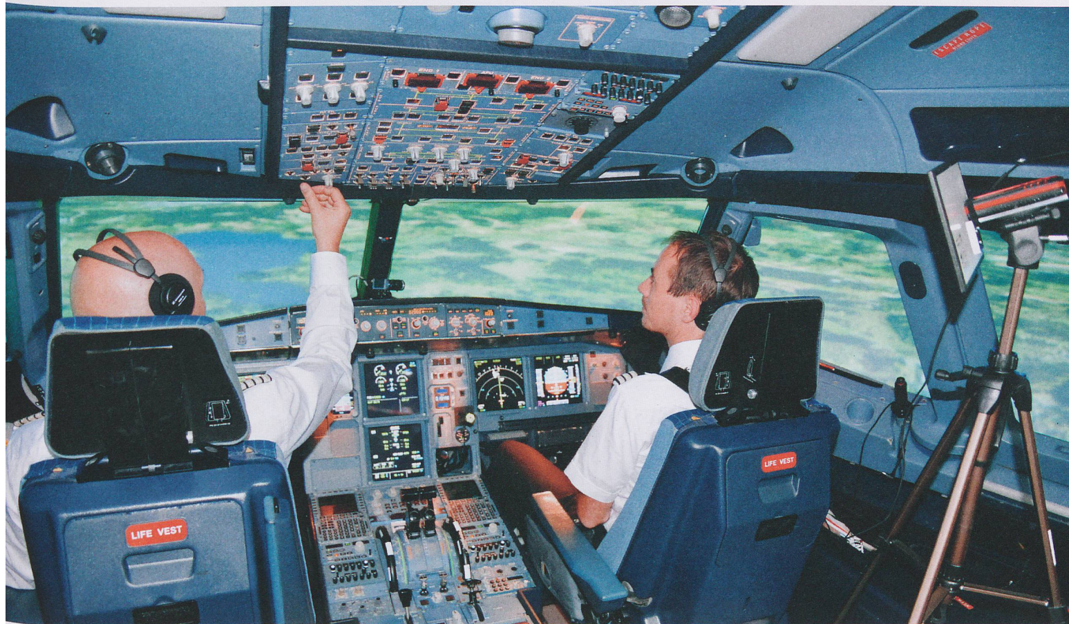
Vier Kameras und Infrarot-Flashes zeichnen die Blicke des Piloten (l.) und des ersten Offiziers im Flugsimulator auf. Die Kombination aus Flash und Kamera ermöglicht es, die Blickrichtung zu berechnen. Bild: David Rudi
