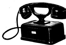
Hotelapparat der eidgen. Telefonverwaltung für Verwendung in Gastzimmern gegen einen jährlichen Abonnementpreis von Fr. 8.— Das Abheben des Hörers stellt die Verbindung mit der Zentrale her.
