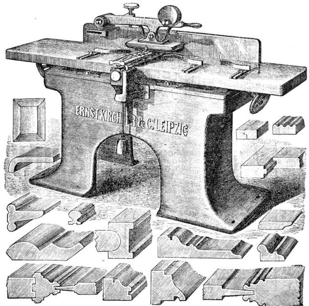
bildung und Beschreibung einer neuen verbesserten Maschine, die bei allen Holzarbeiten die häufigste und vortheilhafteste Verwendung findet, insbesondere ist sie fast unentbehrlich für das Schreiner- und Glasergewerbe, ebenso leistet sie bei der Fabrikation von Kolläden, Blendläden zc. sehr gute Dienste.
