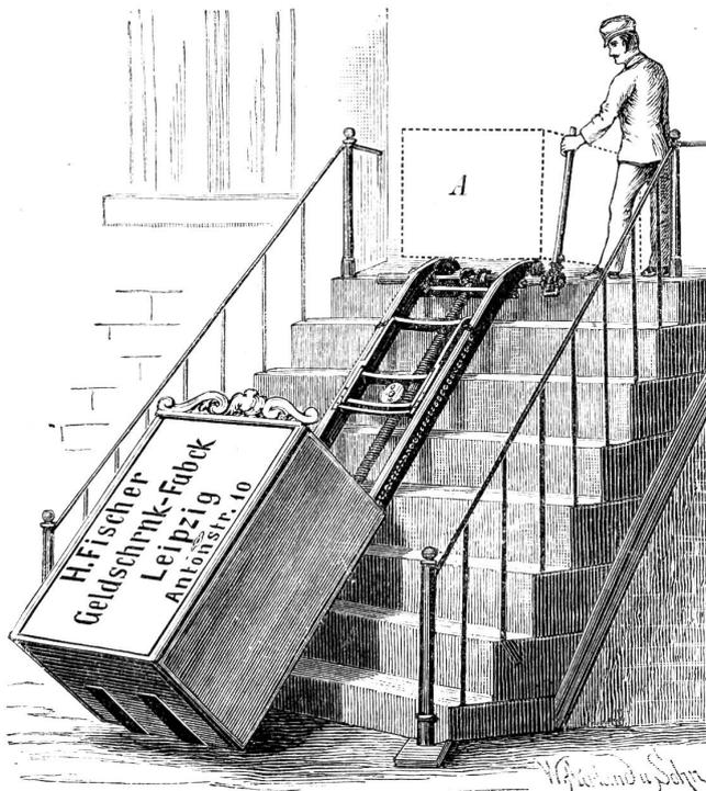
Zwischen den Schienen befindet sich ein Schlitten, welcher durch eine endlose Kette auf und ab bewegt werden
