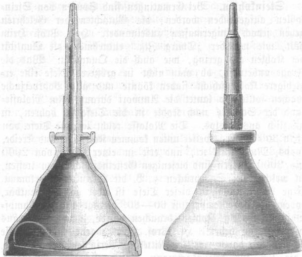
Die Pfeife ist oberhalb der Verschraubung geriffelt, um dieselbe beim Füllen leicht abschrauben zu können. Dadurch daß die Riffelung an der Pfeife, anstatt am Flansch angebracht wurde, konnte die Füllöffnung schalenförmig gestaltet werden, welches ermöglicht, die Kanne ohne einen Tropfen Del zu vergießen, füllen zu können.
