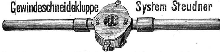
Einfachste, praktischste und billigste Gewindeschneidekluppe mit einmaligem Niederschneiden, fertiges, genaues und sauberes Gewinde. (724)
