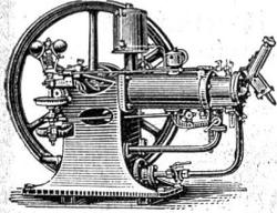
**Gasmotoren** für Leuchtgas.
