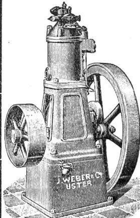
vorzüglicher, bewährtester Konstruktion (System Swiderski Capitaine, patentiert). In mehr als 3000 Exempl. verbreitet, feststehend und fahrbar, (Lokomobile). Geringst. Petroleumverbrauch, kürzeste Inbetriebsetzung, kleinster Raumbedarf, solider Bau. 85
