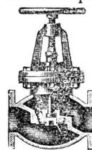
Durch mehrsitigen Kegel garantiert dauernd dichter Schluss u. demzufolge bedeutende Dampfsparnis. — Kein Nachschleifen
