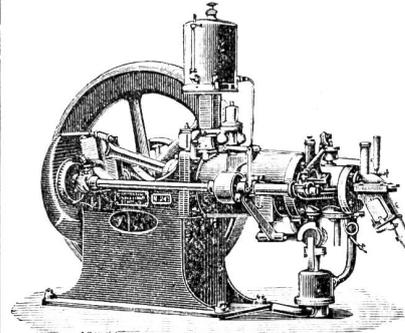
Liegende Konstruktionen, ruhiger, zuverlässiger, geräuschloser Gang; **keine Schnellläufer,**
