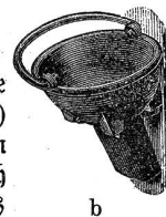
Wärme-Gestell für gewöhnliche Löt Kolben mit Löt Lampe La K H L L.
