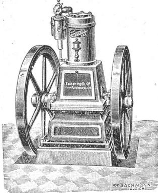
„Meteor“ System Escher Wyss & Cie. Stehende und liegende Anordnung von 1 bis 25 HP und mehr. Einfache Konstruktion, solider Bau, geräuschloser Gang, höchste Leistungsfähigkeit, minimaler Petroleumverbrauch; für Landwirtschaft, Gewerbe, Industrie, elektrisches Licht. — Weitgehendste Garantien. [4:8c]
