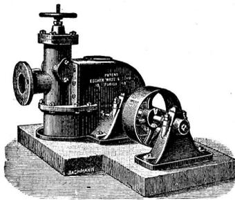
für Hochdruck, mit patentierten Löffelrädern, mit oder ohne automatischem Regulator.
