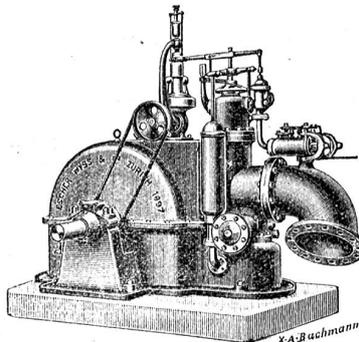
für Hochdruck, mit patentierten Löffelrädern, mit oder ohne automatischem Regulator. Grösste Gleichförmigkeit der Tourenzahl bei den verschiedensten Kraftleistungen. Bequeme Aufstellung, einfache und solide Konstruktion, von unerreichter Leistungsfähigkeit, über 80 Proz. Nutzeffekt. Der billigste und beste Motor für die Kleinindustrie, vorzüglich als Kraftquelle für Elektrizität.
