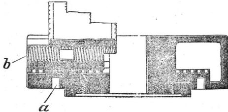
Zu dem Futter werden 3 bzw. 4 Flanschschrauben und 2 Schlüssel für a und b mitgeliefert.
