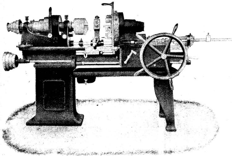
Revolver-Drehbank R 35.
