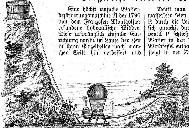
Eine höchst einfache Wasserbeförderungsmaschine ist der 1796 von dem Franzosen Montgolfier erfundene hydraulische Widder. Diese ursprünglich einfache Einrichtung wurde im Laufe der Zeit in ihren Einzelheiten nach mancher Seite hin verbessert und
