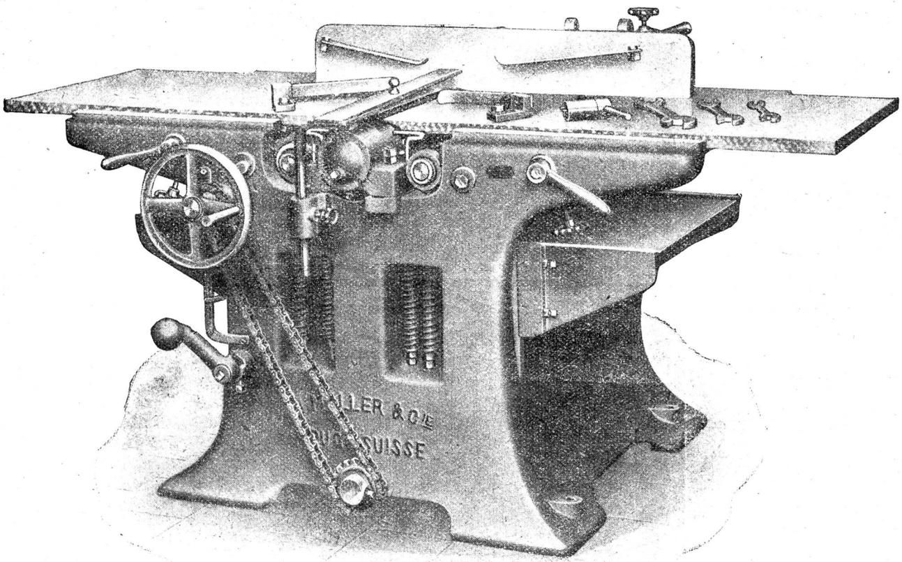
**Kombinierte Abricht- und Dickenhobelmaschine mit Kugellagerung; beide Abrichttische, aus extra starken Flussplatten bestehend, einzeln in der Höhe stellbar mit patentierten federnden Tischwalzen, in Hobelbreiten von 360, 450, 530 und 600 mm. ∴**
