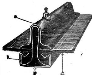
mit Doppelsprossen aus verzinktem Stahlblech und Einglasung auf elastischer Unterlage, für Fabrikbauten jeder Industrie, Hallen, Gewächshäuser etc.
