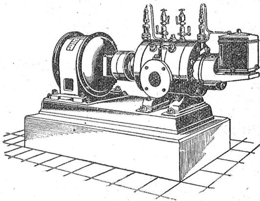
Direkte Kupplung mit Elektromotoren o. Riemenbetrieb.
