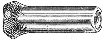
mit eingepresser, quer geschnittener Hartholzfüllung und vorn eingebogener Eisenhülse, in Längen von 30—80 mm und Dicken 9, 11, 14 mm, ist der solideste und zweckmässigste Dübel für alle Zwecke.
