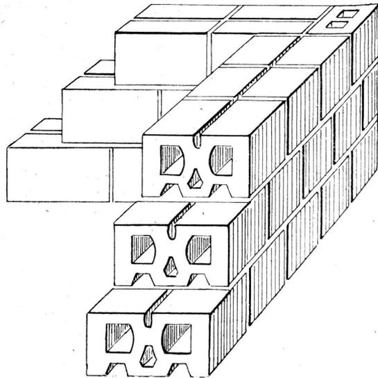
Mauerstärken von 12, 15, 25, 30, 38 usw. cm festhalten, weil Läufer und Binder von 12, 15, 25 und 30 cm hergestellt werden. Die Höhe der Steine von 13 cm entspricht der Höhe von zwei Normalsteinen mit einer Lagerfuge. Es ist demnach möglich, bei Erkerbauten, Anbauten und Reparaturen Aristos mit gewöhnlichem Mauerwerk in richtigen Verband zu bringen.
