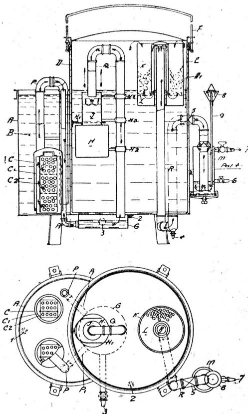
dort eine zweite Karbidabteilung überschwemmt. Von der Gasglocke hat das Gas einen weiteren Durchgang nur durch die Reinigungsmasse des chemischen Reinigers. Der direkte Durchgang, um die Reinigungsmasse herum, wird durch den Wasserverschluss verhindert. Vom Reiniger gelangt das Gas in die Wasserborlage und durch Hahn 7 zur Verwendungsstelle.
