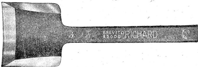
Das neue Hartholzverfahren unterscheidet sich, abgesehen von den verbesserten Hohlseisen in den bisherigen fünf Normalgrößen, nur wenig von den erst genannten beiden Verfahren. Für Fehler über 10 mm Breite dienen zudem Spezialwerkzeuge.
