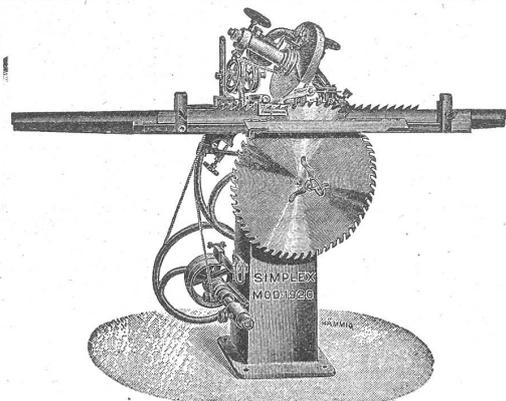
Obige 2 automatischen Sägenschrämmaschinen sind zum Schärren von Gattersägen, Bandsägen und Fräsen konstruiert. Unerreichbar in Solidität und Leistungsfähigkeit. Modell 1920 ist noch extra zum Schärren enger Zahnungen wie Bandsägen und kleiner Fräsen in Schreinereien sowie für Eisenfräsen in mech. Werkstätten konstruiert. 868
