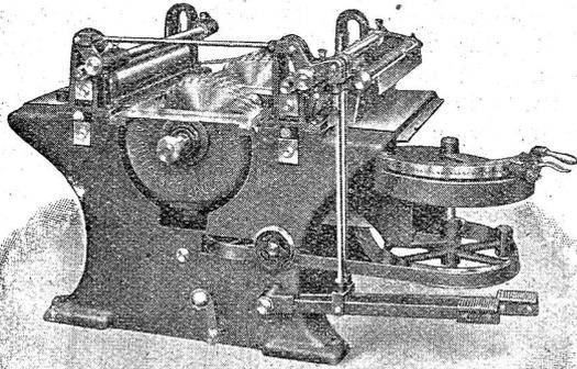
**Doppelte Besäum- und Lattenkreissäge**
