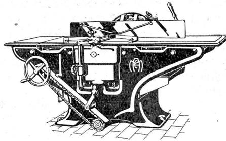
Kombinierte Abricht-, Kehl- und Dickenhobelmaschine 36b
