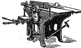
Abrichtbreite: 500 od. 600 mm
