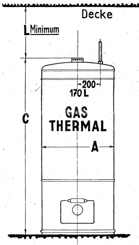
kleiner Gasflamme arbeitet. Die Kosten für Abzugskanäle können also ebenfalls gespart werden, was bei einem Neubau wesentlich ins Gewicht fällt. Andererseits wirkt sich dieser Vorteil auch in bestehenden Häusern aus, wo nachträglich eine Warmwasser-Anlage dieses Systems eingebaut werden soll und Abzugskanäle im vornherein nicht vorhanden sind.
