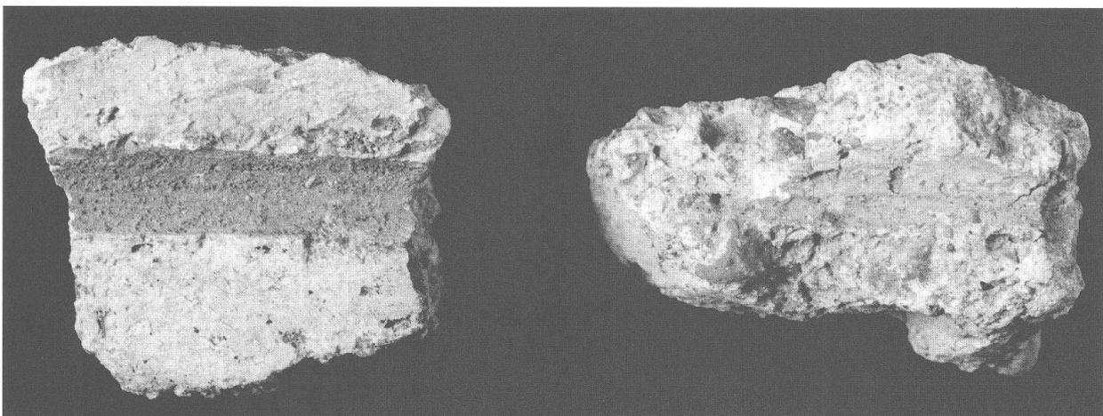
Abb. 86 Augst BL, Grabung 1990.51, Fläche 3. Mörtelfragmente mit rot ausgezogenem Fugenstrich aus dem Verfallschutt des 3. Theaters (Inv. 1990.51.C05323.139–140). M. 1:1.
