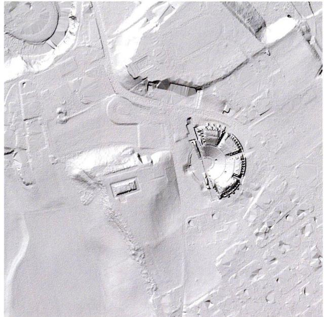
Der bei der Befliegung verwendete Scanner empfängt pro abgehendem Laserstrahl bis zu vier Messungen, wodurch eine gleichzeitige Erfassung von Terrain und Vegetation ermöglicht wird.
