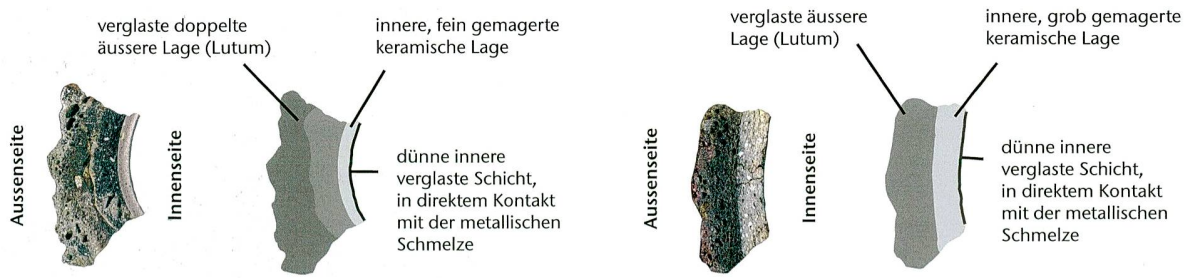
Abb. 5: Querschnitt durch einen fein gemagerten Schmelztiegel (links) mit doppelter äusserer Lage (MRA 67/5437(1)) und einen grob gemagerten Schmelztiegel (rechts) mit einfacher äusserer Lage (MRA 68/1215). M. 1:2.
